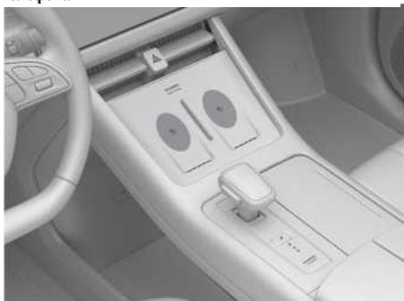
Иллюстрация: расположение беспроводной зарядной панели для мобильного телефона
