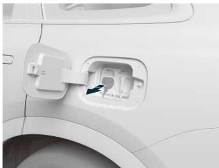
3. Закройте уплотнительную крышку гнезда для медленной подзарядки.
