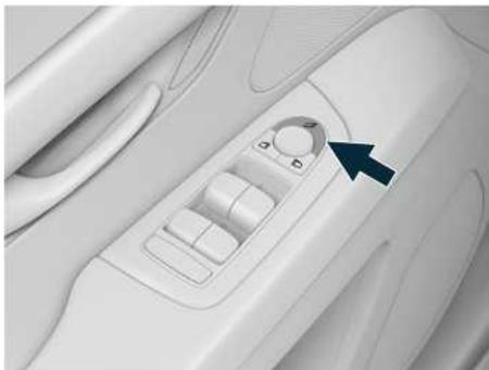
Иллюстрация: кнопка складывания наружных зеркал
