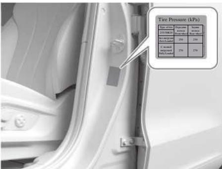
Иллюстрация: расположение таблички с указанием давления в шинах (носит справочный характер, зависит от конкретного автомобиля)
