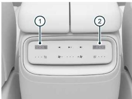
Иллюстрация: Управление подогревом сидений второго ряда на задней панели управления
