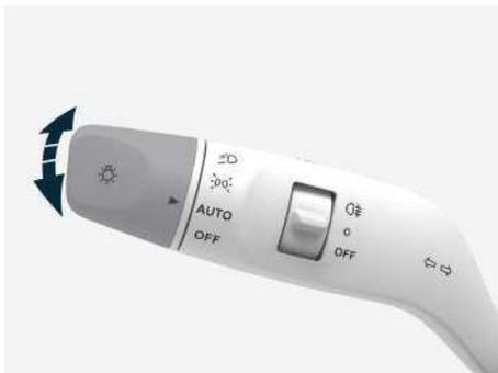
Иллюстрация: поворотный переключатель рычага для регулировки типа наружного освещения
