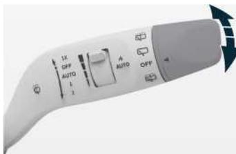
Иллюстрация: поворотный переключатель на рычаге для включения/выключения стеклоочистителей
