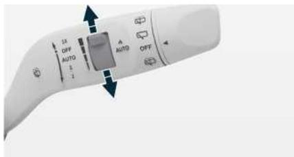
Иллюстрация: перемещение рычага вверх/вниз для регулировки чувствительности стеклоочистителя
