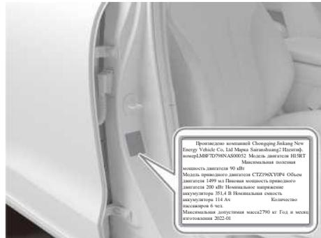
Иллюстрация: расположение заводской таблички автомобиля (носит справочный характер, зависит от конкретного автомобиля)
