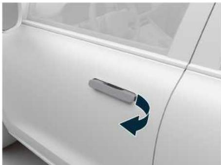
Иллюстрация: разблокировка с помощью внешней ручки двери
