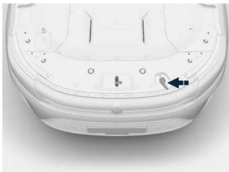
Иллюстрация: рычажок открытия капота
