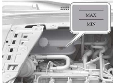
Иллюстрация: Бачок охлаждающей жидкости силового агрегата
