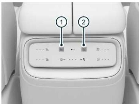
Иллюстрация: Управление функцией массажа сидений второго ряда на задней панели управления
