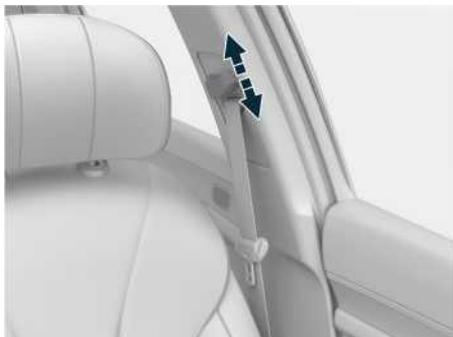
Иллюстрация: регулировка ремней передних сидений по высоте
