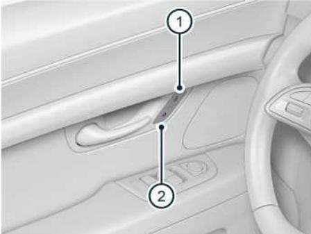
Иллюстрация: кнопка центрального замка дверей со световым индикатором
