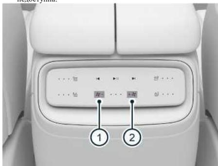
Иллюстрация: Физическая кнопка регулировки заднего кондиционера
