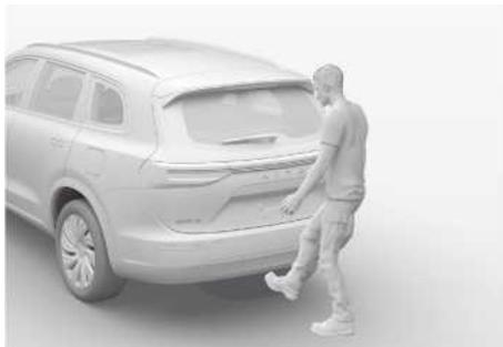
Иллюстрация: датчик бесконтактного открытия багажника ногой расположен под бампером
