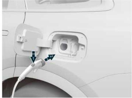
6. Удерживайте кнопку ① на пистолете для подзарядки, снимите защитную крышку пистолета для подзарядки ②.
