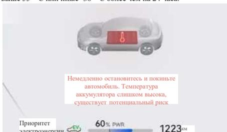
Иллюстрация: дисплей прибора, предупреждение о перегреве аккумуляторной батареи (отличается в зависимости от версии, ориентируйтесь по интерфейсу конкретного автомобиля)
