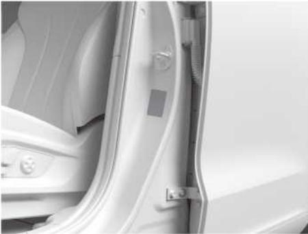
Иллюстрация: табличка с указанием давления в шинах находится в нижней части левой колонки В.
