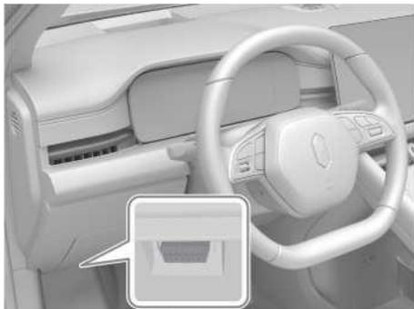
Иллюстрация: OBD расположен в левом нижнем углу приборной панели со стороны водителя
