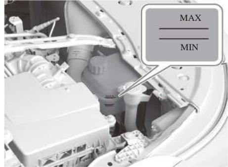
Иллюстрация: Бачок охлаждающей жидкости ДВС
