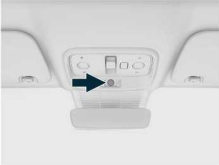
Иллюстрация: камера внутри автомобиля
