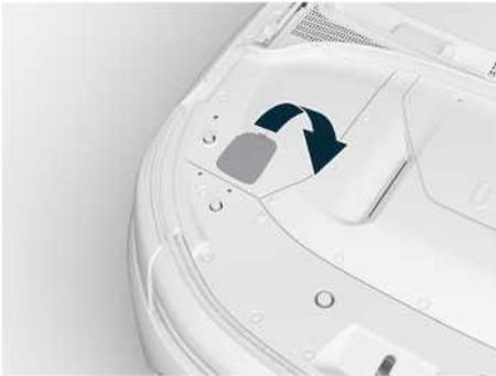
Иллюстрация: крышка бачка жидкости стеклоомывателя
