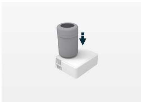
Иллюстрация: установка емкости с герметиком
