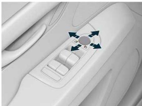
Иллюстрация: круглая кнопка регулировки направления наружного зеркала заднего вида
