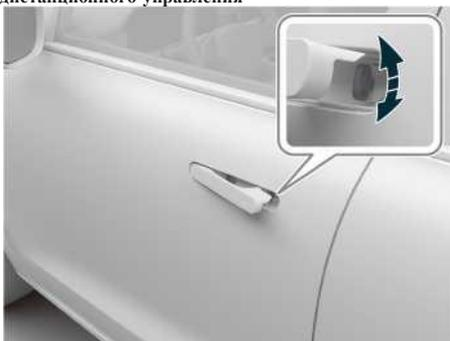
Иллюстрация: место использования механического ключа
