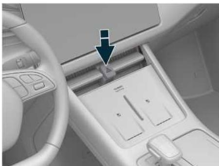
Иллюстрация: включение аварийной сигнализации
