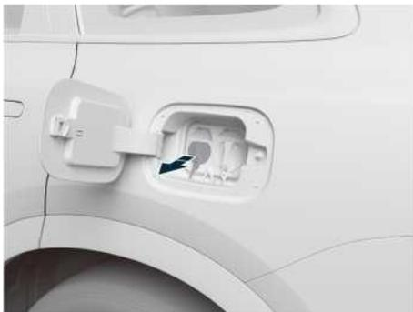
3. Закройте уплотнительную крышку гнезда для медленной подзарядки.
