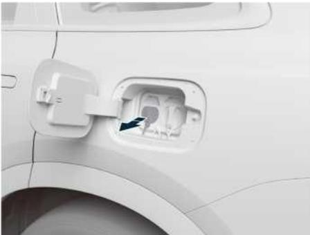
5. Закройте уплотнительную крышку гнезда для медленной подзарядки.
