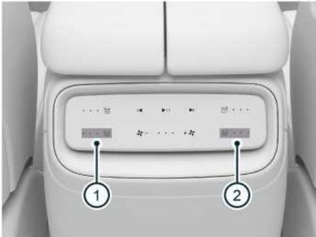
Иллюстрация: Управление вентиляцией сидений второго ряда на задней панели управления
