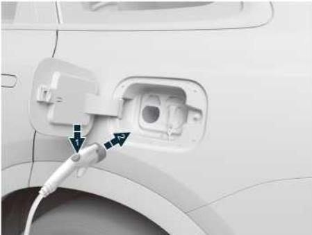
4. Удерживайте кнопку ① на пистолете для подзарядки, снимите защитную крышку пистолета для подзарядки ②.
