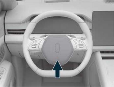
Иллюстрация: включение звукового сигнала
