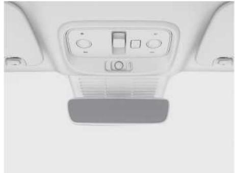
Иллюстрация: внутреннее зеркало заднего вида с автоматическим затемнением
