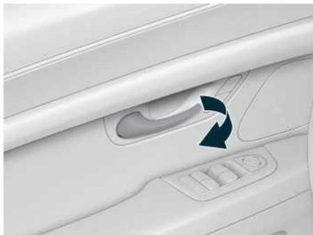
Иллюстрация: разблокировка с помощью внутренней ручки двери
