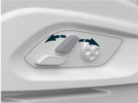
Иллюстрация: кнопка регулировки угла наклона спинки
