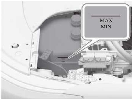
Иллюстрация: Бачок охлаждающей жидкости силового агрегата
