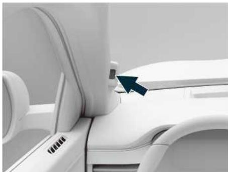
Иллюстрация: положение камеры контроля состояния водителя
