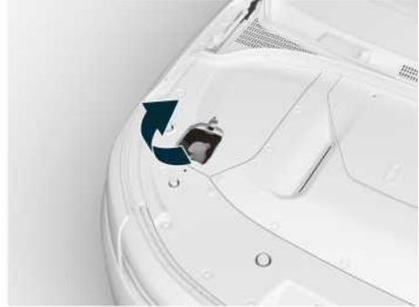
Иллюстрация: отверстие для долива жидкости в бачок стеклоомывателя
