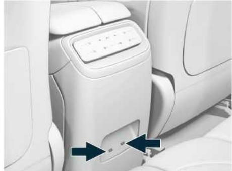
Иллюстрация: разъем питания Type C на передней вспомогательной приборной панели возле второго ряда сидений
